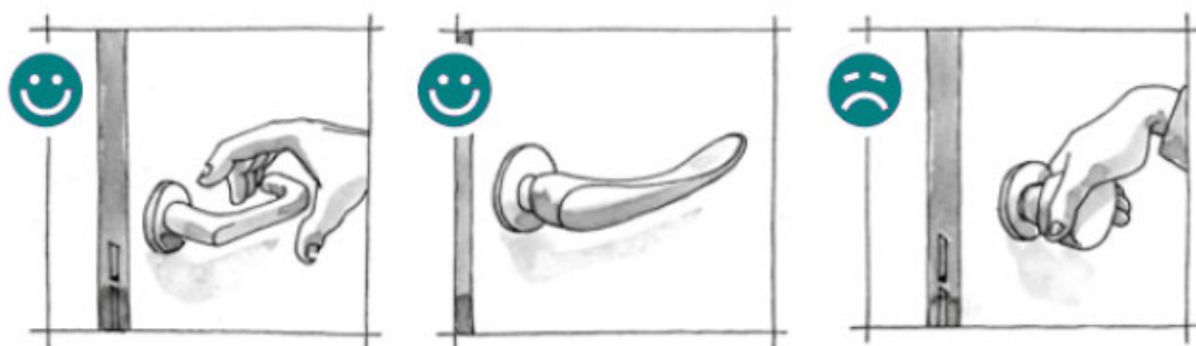
Schéma 8 : évitez les poignées de porte en forme de gros bouton arrondi car ils sont moins préhensibles
